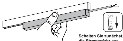
Trennen Sie Neutralleiter, Phase und Schutzleiter vom Netzteil. Bei ordnungsgemäßer Montage der Schiene, einfach das Gehäuse des Netzteiles fest herausziehen.
