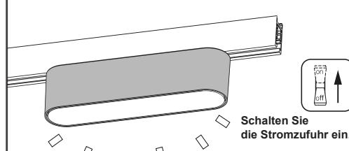
Nach der Installation den Strom einschalten. Wenn die Leuchte nicht leuchtet, den Strom ausschalten, alle Geräte entfernen und auf Auffälligkeiten prüfen, bevor sie wieder installiert werden.
